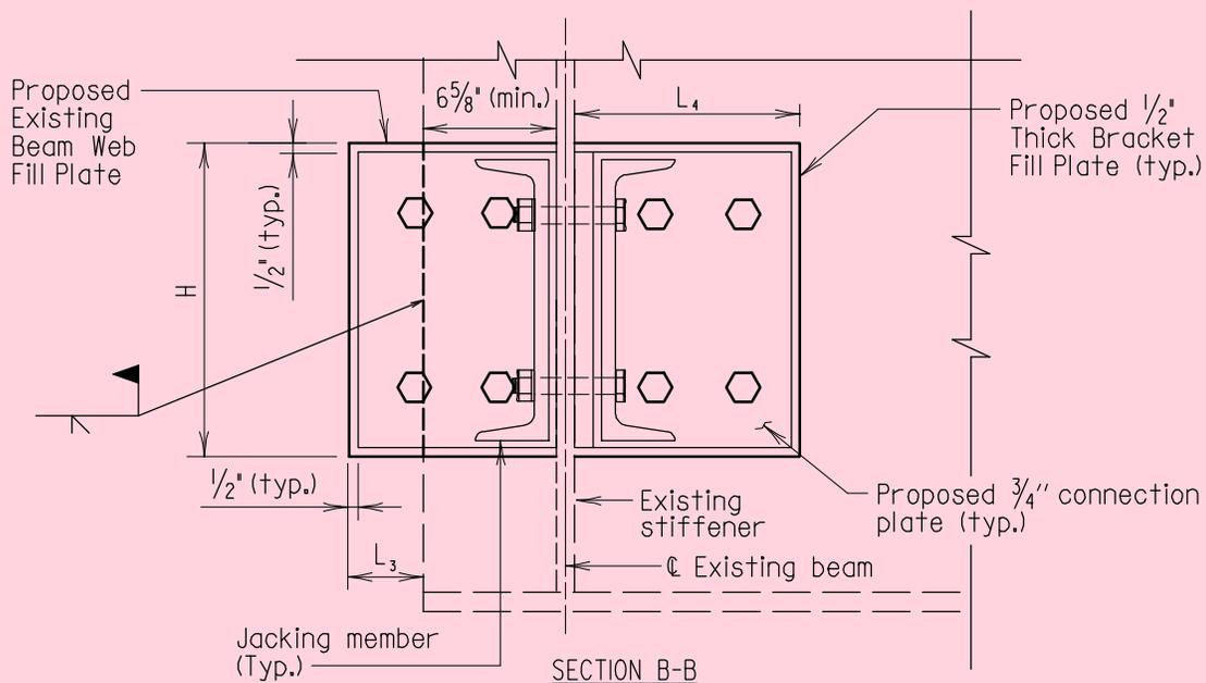
EXISTING BEAM WEB FILL PLATE DETAIL
